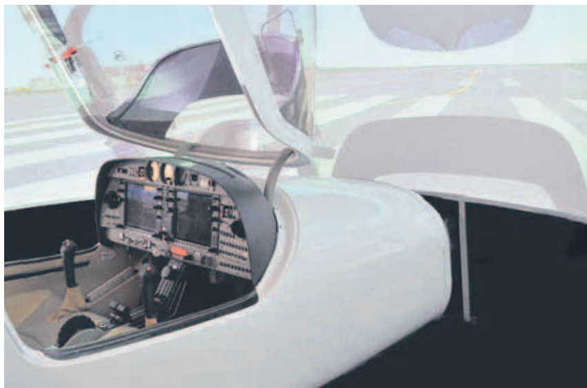
Die perfekte Illusion: Dieser Simulator entspricht exakt dem Flugzeug DA42 Twin Star.
