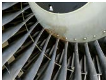
Im linken Triebwerk sind die Blutflecken und Federn zu sehen.
