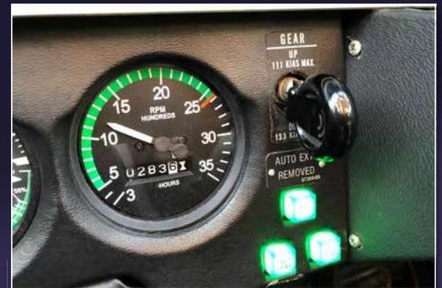
Der erste Fahrwerkshebel, den ich in meiner Karriere betätigen darf: Er gehört der Piper PA-28RT-201T Turbo Arrow IV. Die drei grünen Lampen bestätigen, dass das Fahrwerk ausgefahren und korrekt verriegelt ist (Tis Meyer, 2017).
