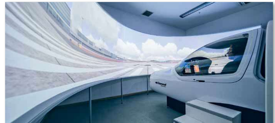
Den Grossteil dieser Ausbildungsphase bestreitet der Flugschüler im zum Flugzeug baugleichen Simulator, von denen im Flugschulgebäude der Horizon zwei Stück verfügbar sind. Da der Instruktor alle denkbaren Umwelt- und Beschädigungsszenarien einspielen kann, ist der Simulator ein hervorragendes Mittel, um künftige Piloten auf alle Eventualitäten vorzubereiten (Bild: Horizon SFA).
